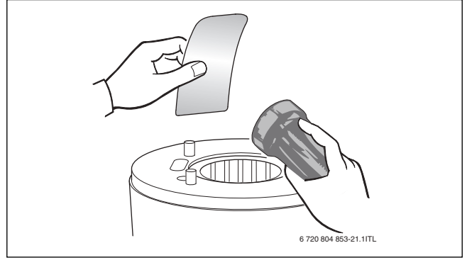
Res. 49 Yanma gövdesinin atık bakımından kontrolü
